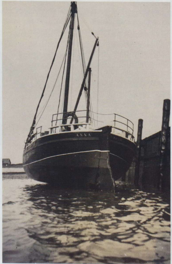
Die Anna in den dreißiger Jahren trockenengefallen in Steenodde, gut erkennbar das breite und flache Unterwasserschiff
