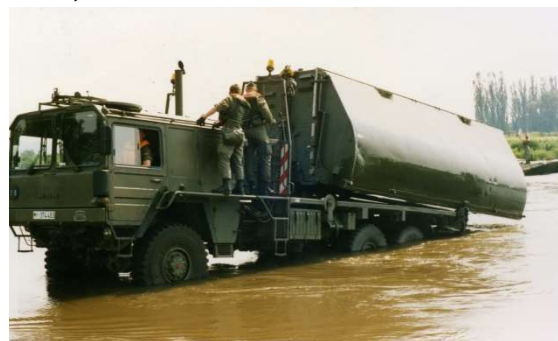
Faltschwimmbrücke (FSB) auf Transportfahrzeug MAN 7t
