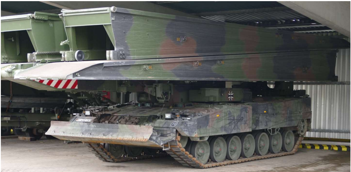
Panzerschnellbrücke 2 LEGUAN Gep Brückenlegesystem auf Basis Leopard 2
