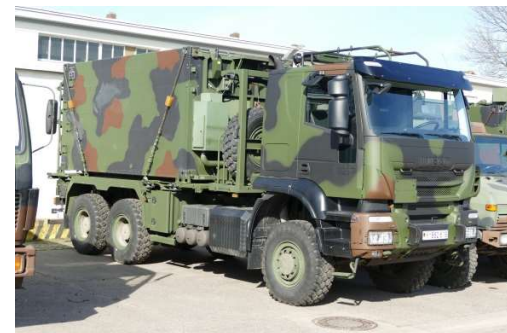
Lkw 5 t IVECO mit Kabine FmB (von Bw FPS)
